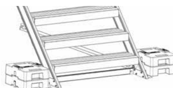
Treppenfuß mit Auflasttraverse
